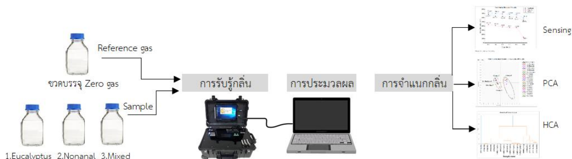
ภาพที่ 3 การทดลองตรวจวัดกลิ่นตัวอย่างด้วยเครื่องจุลอิเล็กทรอนิกส์
