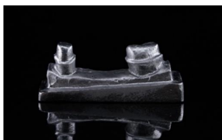
ภาพที่ 1 ก) ภาพด้านข้าง และ ข) ภาพด้านบนของแบบจำลองโลหะเหวี่ยงชนิดโลหะผสมโคบอลท์โครเมียม
